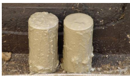
POBRANE PRÓBKI Z UROBKU CEMENTOWO-GRUNTOWEGO
